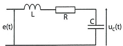
On rappelle qu'à ces tensions sont associées les amplitudes complexes  $U_{Cm} = \frac{E_m}{(1-x^2) + j\frac{x}{Q}}$  et  $U_{Rm} = \frac{E_m}{1 + jQ\left(x - \frac{1}{x}\right)}$
