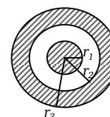
Cette ligne est supposée relier un générateur continu à une charge ohmique. On désigne par  $R_1$  la résistance de l'un des deux conducteurs,  $R_2$  la résistance de l'autre conducteur et  $R'$  la résistance de fuite, c'est-à-dire la résistance de l'isolant vis-à-vis du courant de fuite entre les deux conducteurs.
