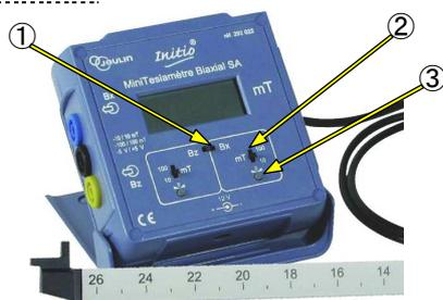
① sélection sonde ( $B_x / B_z$ ) ; ② calibres ; ③ calibrage
