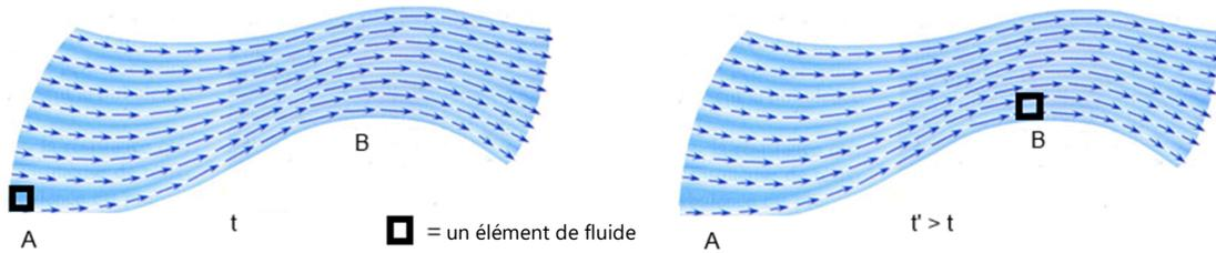
Par stationnarité on a bien :  $\vec{v}(A, t) = \vec{v}(A, t')$  et  $\vec{v}(B, t) = \vec{v}(B, t')$ , mais en revanche  $\vec{v}(A, t) \neq \vec{v}(B, t')$ .
