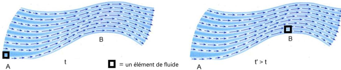
Par stationnarité on a bien :  $\vec{v}(A, t) = \vec{v}(A, t')$  et  $\vec{v}(B, t) = \vec{v}(B, t')$ , mais en revanche  $\vec{v}(A, t) \neq \vec{v}(B, t')$ .
