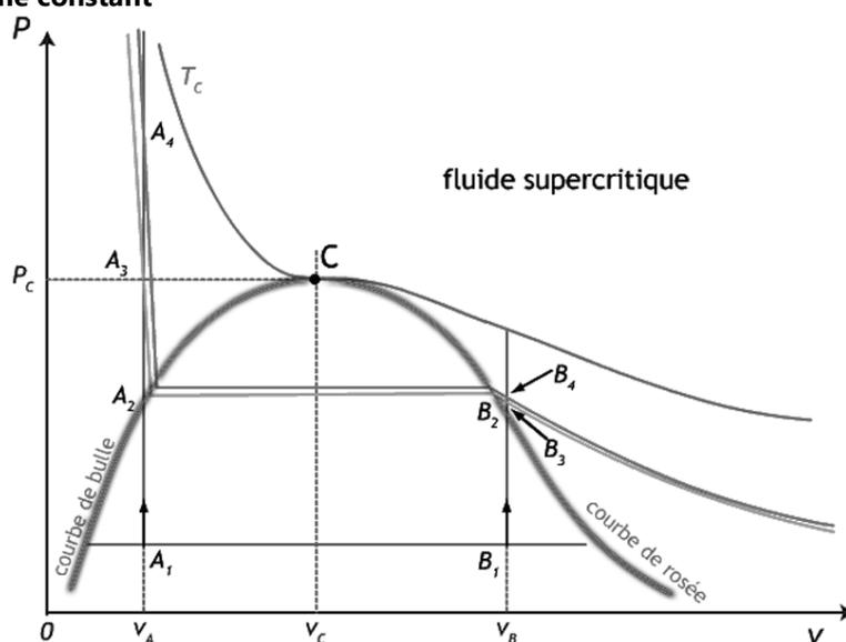
**T 89. Détente et vaporisation d'eau en écoulement stationnaire**
