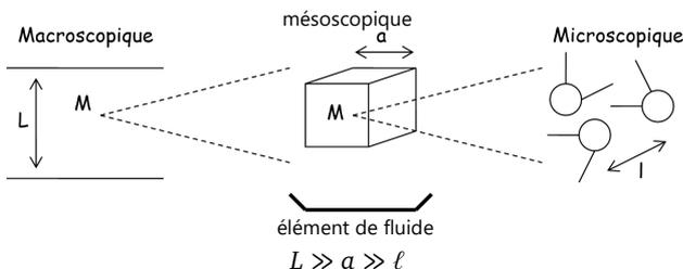
$L \sim 10 \text{ cm} = 10^{-1} \text{ m}$  ;  $a \sim 0,1 \text{ mm} = 10^{-4} \text{ m}$  ;  $\ell \sim 10 \text{ nm} = 10^{-8} \text{ m}$
