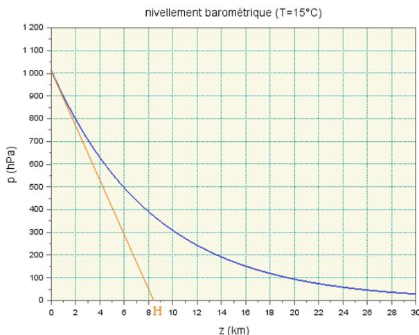
$$p(z) = p(0) e^{-\frac{z}{H}} \quad \text{formule dite du nivellement barométrique.}$$
